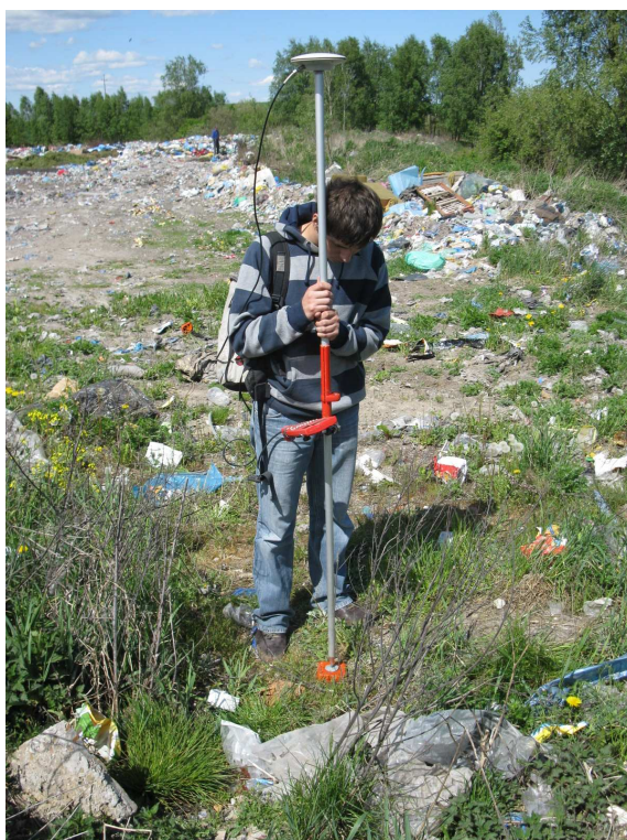
Fot. 5. Pomiar metodą statyczną (zdjęcie poglądowe)
