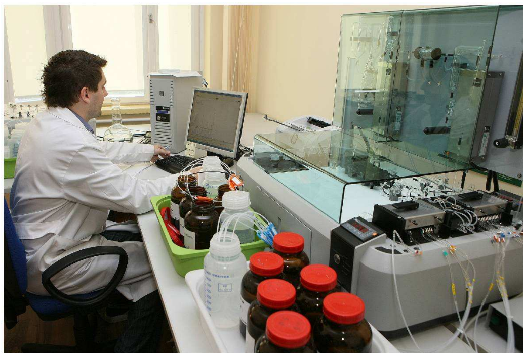
Fot. 1. Analizator przepływowy typu SAN ++ , firmy Skalar
